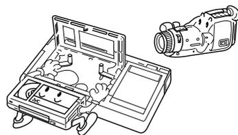
\* Des enregistrements de caméscope VHS compact peuvent être lus sur ce magnétoscope. Placer simplement la cassette enregistrée dans un adaptateur de cassette VHS et elle peut être utilisée comme toute cassette VHS de taille standard.
